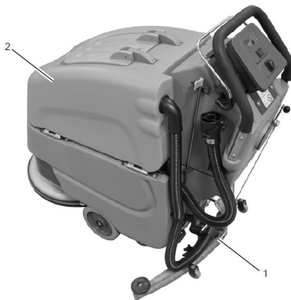
Slika 6: 1 sesalna šoba in 2 rezervoar za umazano vodo
